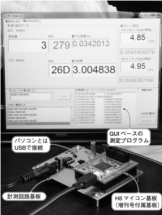
写真1 製作したパソコンを使った計測システム
