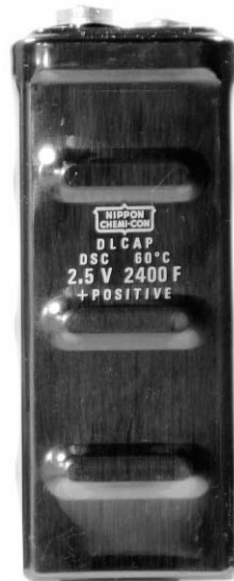
写真1 実験に使った電気二重層キャパシタ DSC シリーズ (2.5 V, 2400 F, 日本ケミコン)
