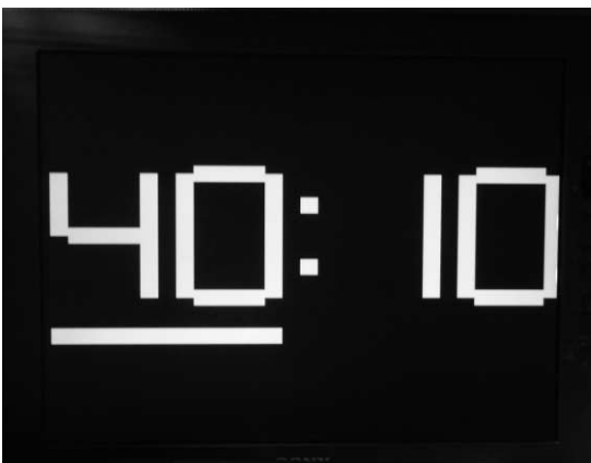
写真1 CPLDを利用して製作した得点表示器による表示画面
