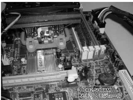
写真8-1 DDR2メモリを搭載したマザーボード
