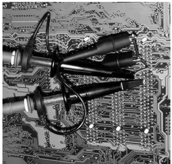
写真8-4 PCIバスの信号をオシロスコープのプローブで見ているところ
