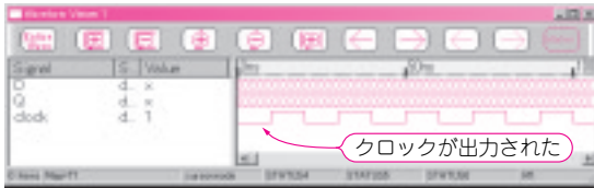
図5-2 Dフリップフロップのclock端子に信号が入ったのがわかる
