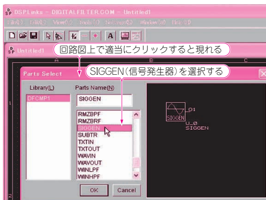
図3-2 配置するコンポーネントを選ぶ「Parts Select」ダイアログ
