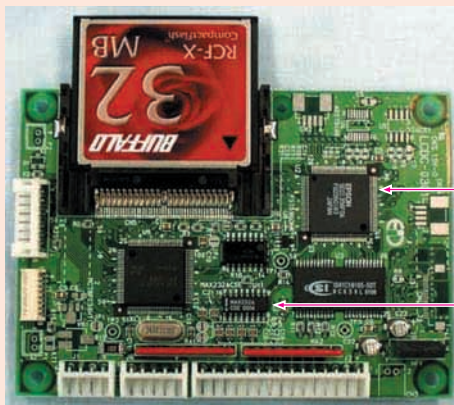
◀ <写真D> EIA-232インターフェース付きのLCD制御基板…この基板にディスプレイ・ドライバと液晶パネルを接続し、簡単なコマンドを送るだけで文字やグラフを描画できる(第5章)
