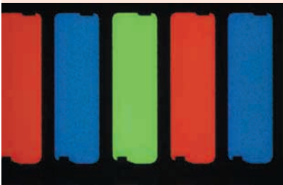
◀ <写真A> 液晶パネルの表面を顕微鏡で観察したところ、RGBのカラー・フィルタが見える
