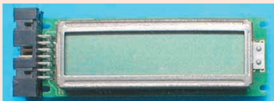
<写真E> LCDキャラクタ・ディスプレイ・モジュール…データ・バス8本と制御信号3本で文字や記号を表示させることができる。価格も手ごろ(第6章)
