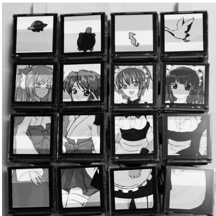
写真2 16組の有機ELディスプレイ基板(OB)/付属基板(MB)で大きいビットマップ・データを表示 大人買いによるマルチ・ディスプレイもどきである。USBケーブル1本で1カ所の付属基板(MB)から給電させるのは最大で4～8組程度の有機ELディスプレイ基板(OB)/付属基板(MB)にするのが安心。ここでは3カ所から給電している(USBによる給電×2カ所、ACアダプタ接続基板PBによる給電×1カ所)
